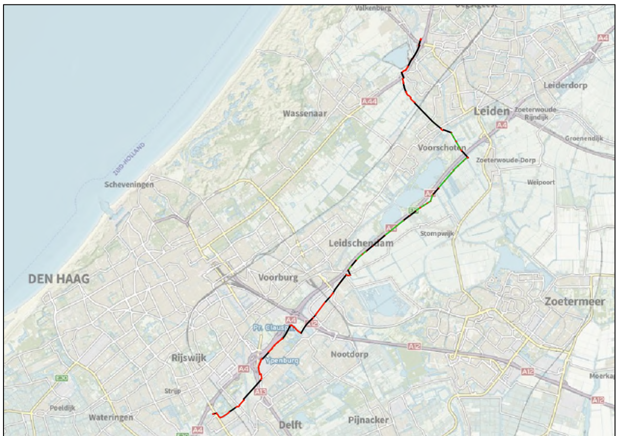
Figuur 1.1: Topografische ligging tracé WarmtelinQ Rijswijk-Leiden met in rood aanleg in open ontgraving, in zwart aanleg in boringen en in groen aanleg door inploegen. In bijlage 1 is het tracé in meer detail weergegeven. Bron ondergrond: TopoPlus.
