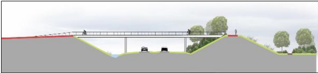
Figuur 3.16 Doorsnede van recreatieve passage over de Verlengde Bentwoudlaan heen
