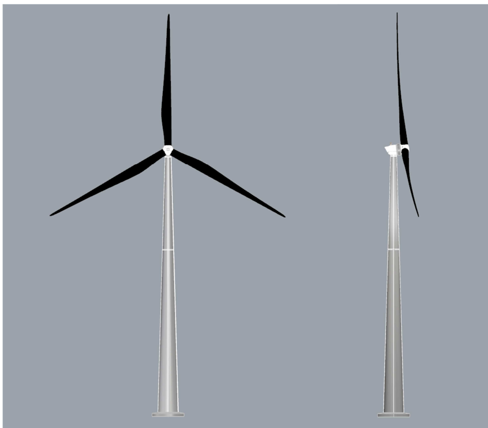
Figuur 5. De Lagerwey L136 met een opgewekt vermogen van 3.6 MW, een ashoogte van 140 m en een rotordiameter van 136 m. De hier afgebeelde turbine heeft echter een ashoogte van 132 m.
