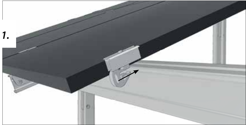
Fig. 6.1.-1 (attaching the module clamp)
