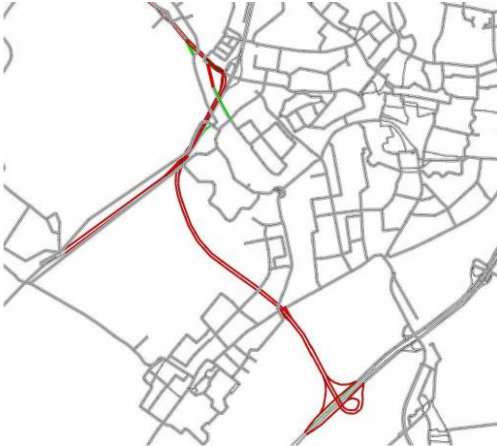
Figuur 8: Tracé N11 West, variant 1 t/m 4 (uitbreidingen van het referentienetwerk zijn rood, verwijderde wegen zijn groen)
