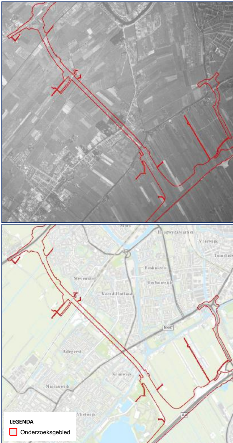
Figuur 30: Luchtopname van 9 juli 1945 (boven) en een kaart van de huidige situatie (onder) ter plaatse van de aan te leggen verbindingsweg tussen de snelwegen A4 en A44. Uit een vergelijking van de twee beelden is op te maken dat er ter plaatse van het nieuw aan te leggen tracé voornamelijk weilanden aanwezig zijn.
