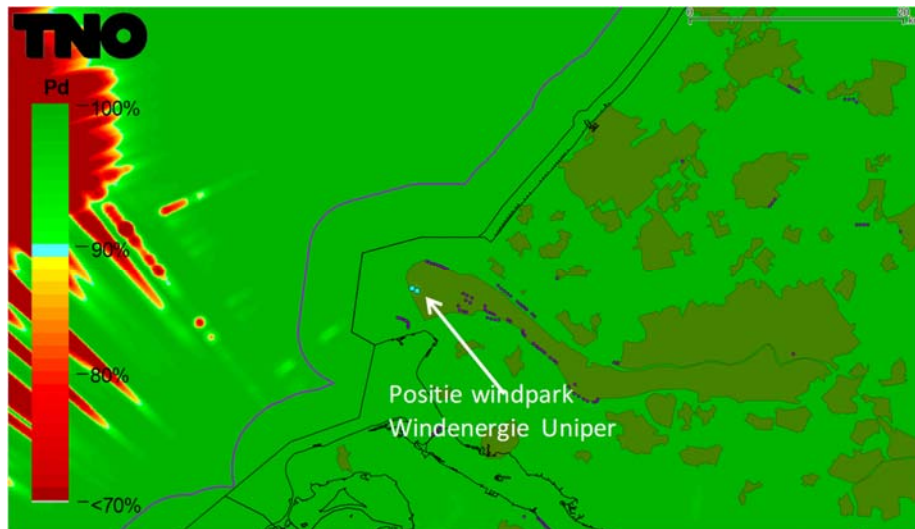
Figuur 11 Detectiekans van het primaire verkeersleidingsradarnetwerk op 1000 voet boven bouwplan nadat deze is gerealiseerd. De locatie van de nieuwe windturbines behorend bij variant B is aangegeven met blauwe stippen.
