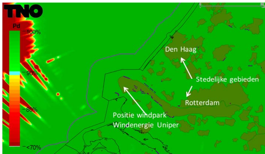
Figuur 5 Detectiekans van het primaire verkeersleidingsradarnetwerk op 1000 voet boven het bouwplan voordat dit is gerealiseerd (baseline).
