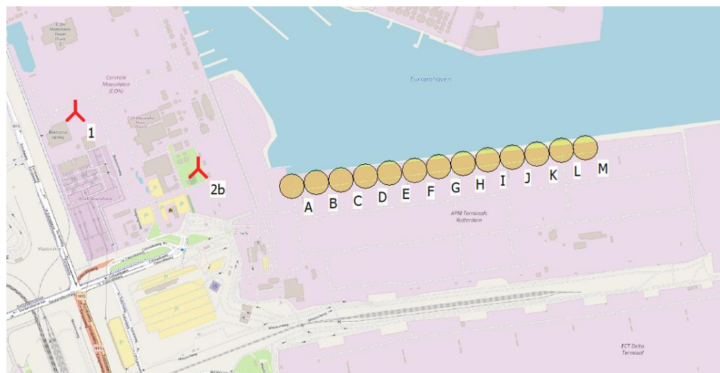
Figuur 3.3 Positionering toetspunten dynamische kranen (A is lager dan overige toetspunten)
