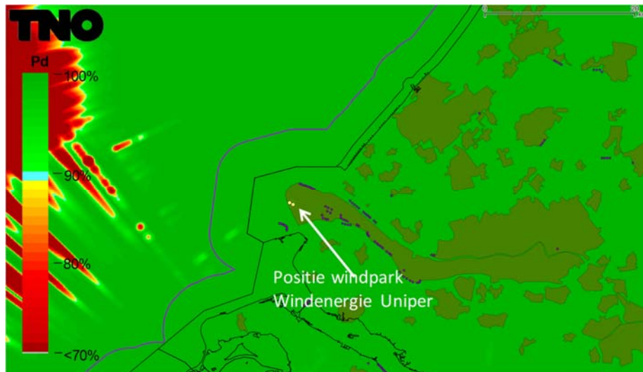
Figuur 6 Detectiekans van het primaire verkeersleidingsradarnetwerk op 1000 voet boven bouwplan nadat deze is gerealiseerd. De locatie van de nieuwe windturbines behorend bij variant A is aangegeven met gele stippen.
