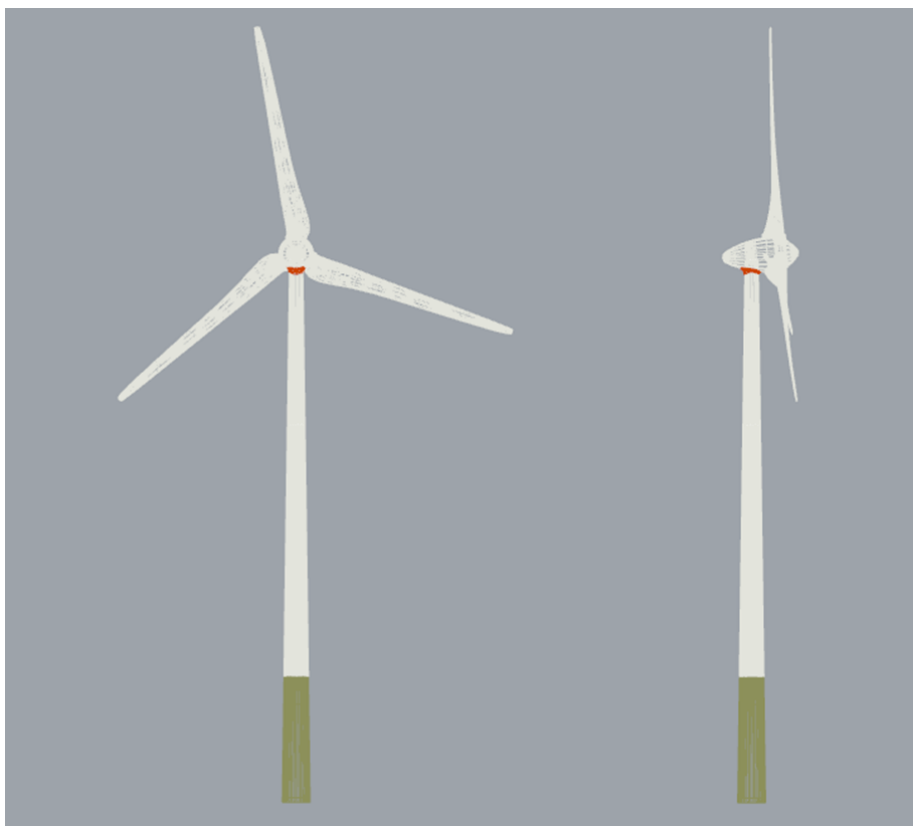
Figuur 5. De windturbine van Enercon, type E-70, met een opgewekt vermogen van 2.3 MW, een stalen mast met een ashoogte van 85 m en een rotordiameter van 71 m.
