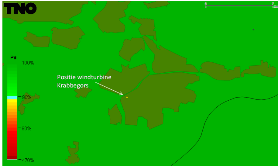
Figuur 7 Detectiekans van het MASS primaire verkeersleidingsradarnetwerk op 1000 voet boven het bouwplan nadat deze is gerealiseerd. De locatie van de windturbine is aangegeven met een gele stip.
