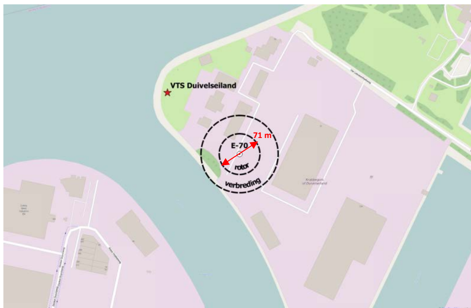
Figuur 26: Op een afstand van 1200 vanaf de positie van de windturbine kunnen echos van de windturbine zichtbaar zijn binnen de cirkel aangegeven op bovenstaande kaart. De binnenste cirkel geeft de rotordiameter weer. De buitenste cirkel geeft de weergave van de windturbine weer op een afstand van 1200 m. De verbreding van de windturbine strekt zich precies uit tot op de waterkant.
