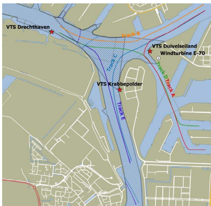
Figuur 12: De berekende spooktrajecten voor VTS Krabbepolder. Alleen voor track C en E is een korte spooktraject waar te nemen.
