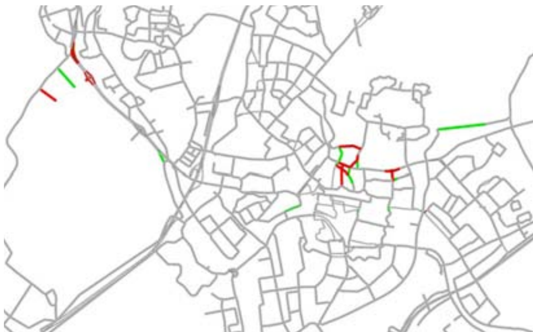
Figuur 13: aanpassingen in het referentie-netwerk voor de gevoeligheidsanalyse (uitbreidingen van het netwerk zijn rood, verwijderde wegen zijn groen)
