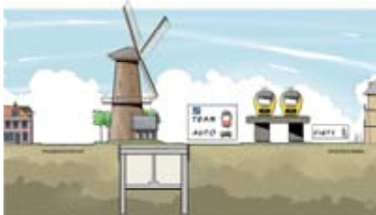
Figuur 8.3 Fasering bij realisatie gegraven Spoortunnel Delft
