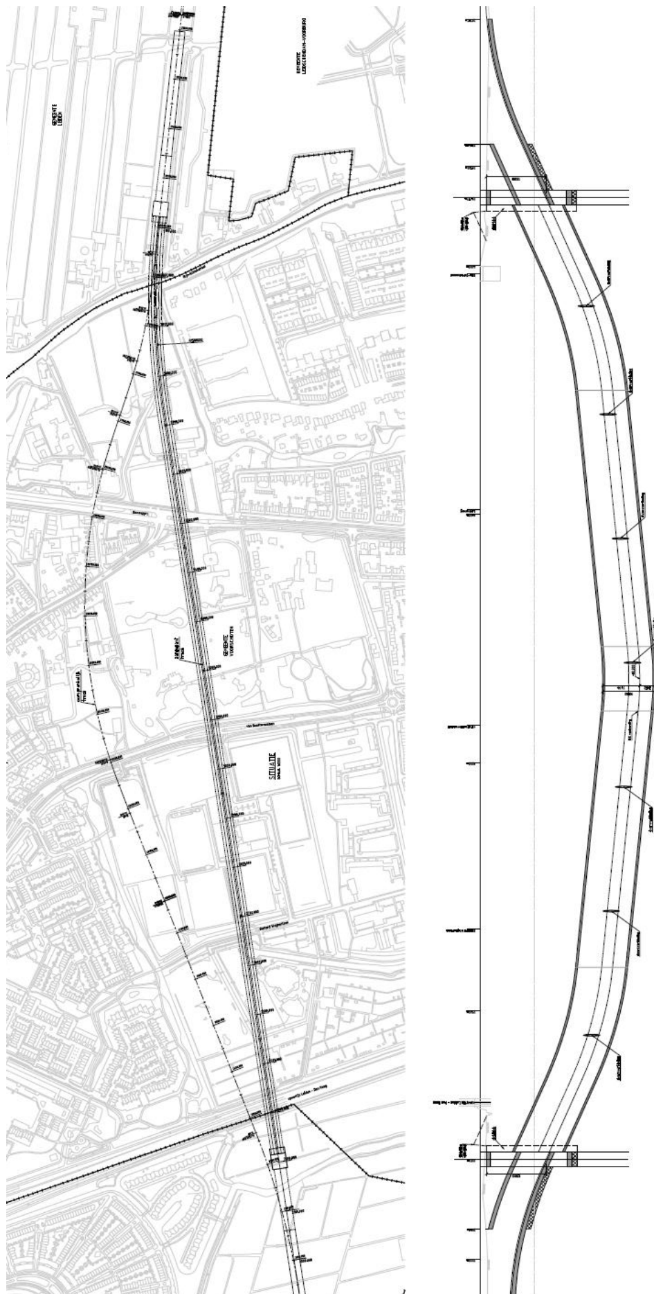
Afbeelding 13 Lengteprofiel tunnel volgens Haalbaarheidsonderzoek Movares
