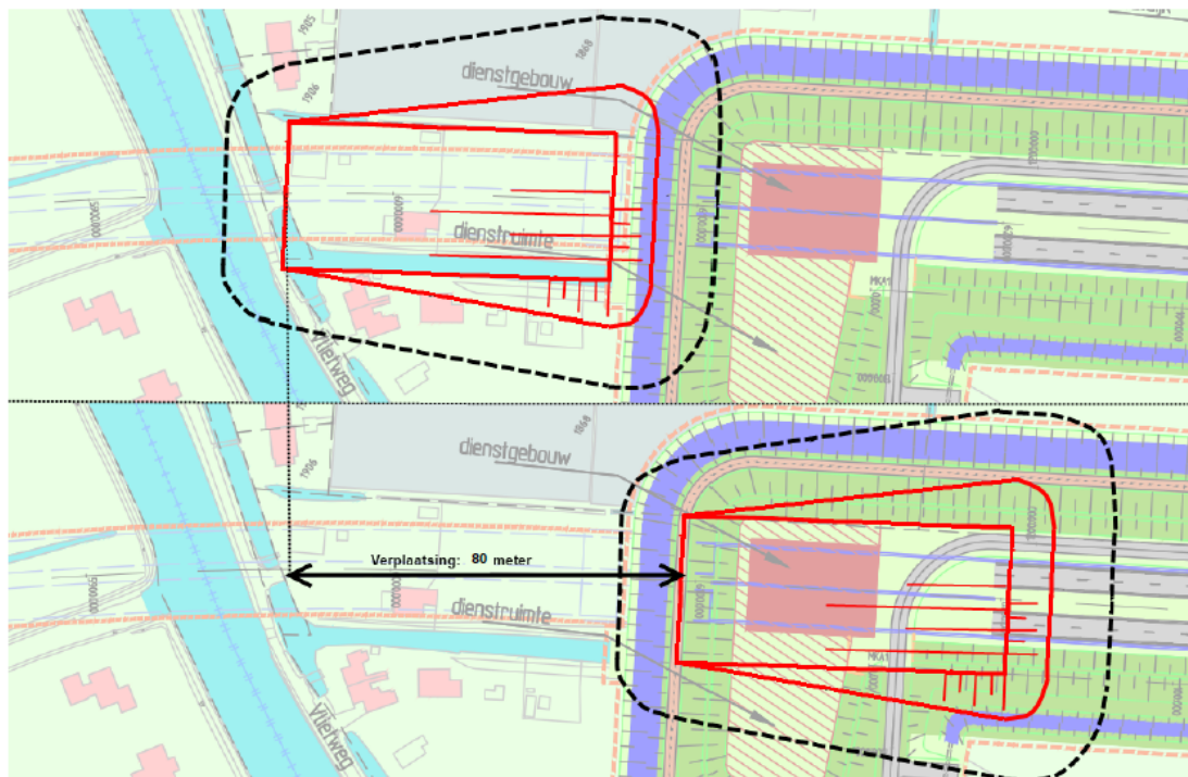
Afbeelding 4 Gewijzigd alignement als gevolg van verplaatsing startschacht (oostzijde)
