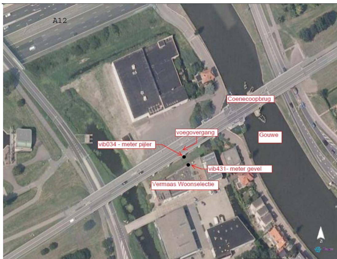
Figuur 2.2 Meetlocaties referentiesituatie Coenecoopbrug en Vermaas Woonselectie, afstand pijler tot gevel bedraagt circa 8 meter, boven de pijler is een voegovergang aanwezig
