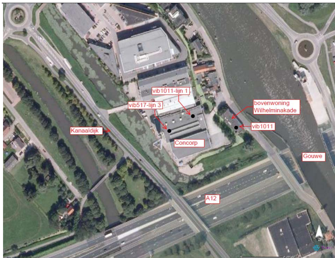
Figuur 2.1 Meetlocaties nulsituatie Concorp en bovenwoning Wilhelminakade. Vib1011 is productielijn 1 en vib517 is productielijn 3
