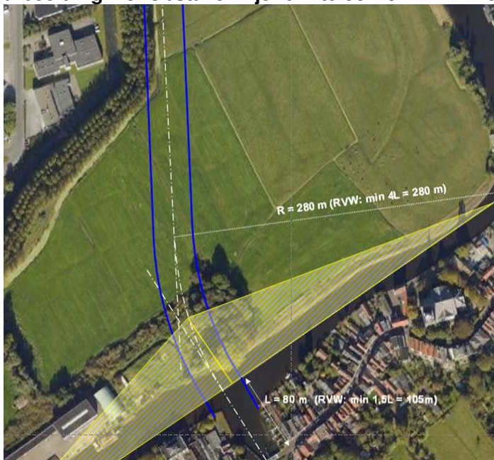
afbeelding 4.3. Obstakelvrije ruimte conform RVW2005
