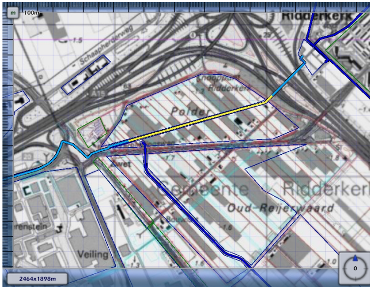
Figuur 2.2 Ligging van de kilometer met het hoogste groepsrisico (geel) van buisleiding A517.
