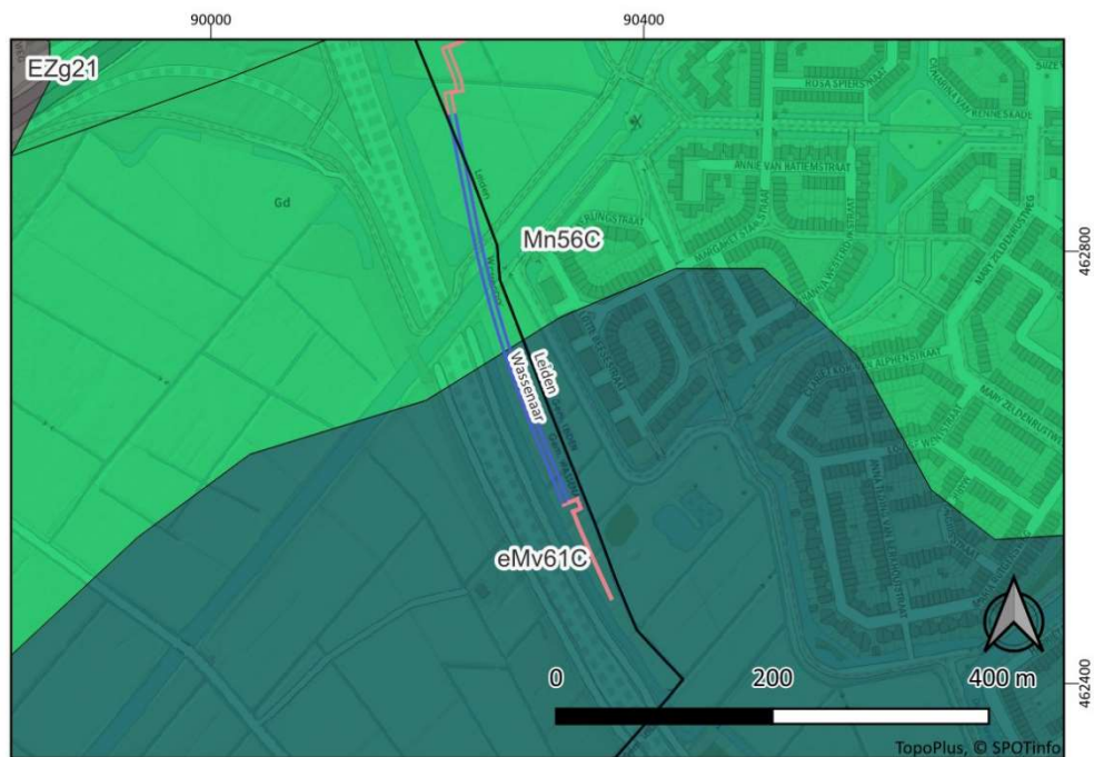
Afbeelding 7. Uitsnede van de bodemkaart van Nederland met het plangebied. Aanleg door middel van open ontgraving = rode lijn, aanleg door middel van sleufloze technieken = blauwe lijn. (bron: Esri & Partners).
