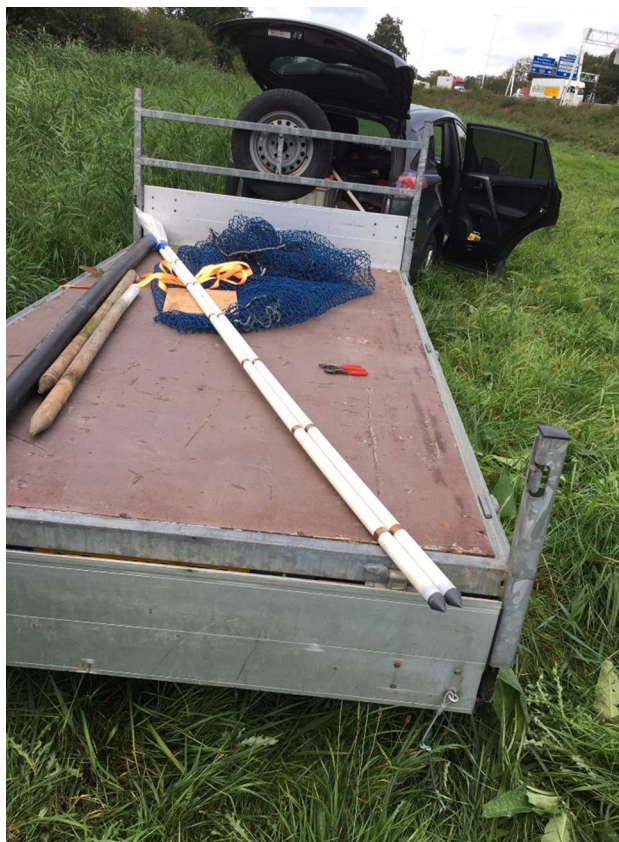
Figuur 3.2 Meetlansen met temperatuursensoren
