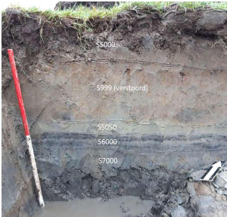
Figuur 5.2. Profiel 1201 van put 12 (deelgebied noord) met van boven naar beneden bouwvoor (S5000), verstoorde dekafzettingen (S999), een laatste restje intacte dekafzettingen (S5050), kwelderafzettingen met dubbele laklaag (S6000) en estuariene afzettingen (S7000).
