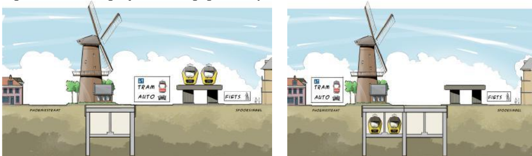
Figuur 8.3 Fasering bij realisatie gegraven Spoortunnel Delft
