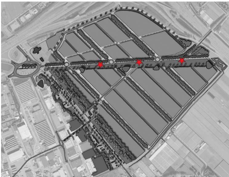
Figuur 4.3 Variant 9 MW. Drie windturbines met een ashoogte van 100 meter en een onderlinge afstand van circa 380 meter. De turbines staan in het water aan de zijde van de weg.
