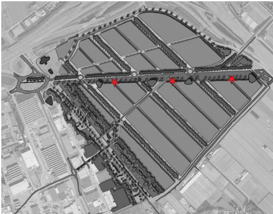
Figuur 4.1 Variant MER 80. Drie windturbines met een ashoogte van 80 meter en een onderlinge afstand van circa 440 meter. De turbines staan in het water aan de zijde van de bebouwing.
